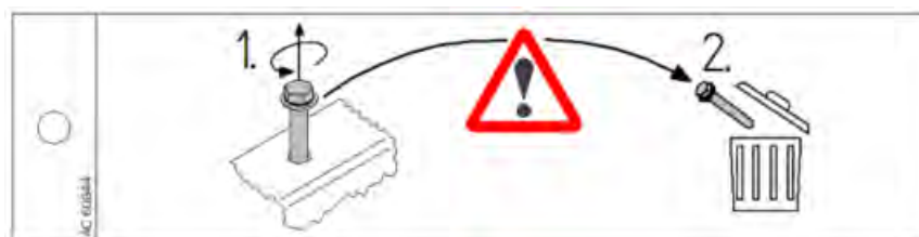
60844 - Śruba zabezpieczająca transport (z hydroBLU)
